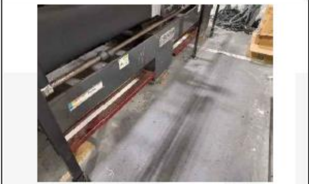
Foto 29 Perigo 2.1, Pedal de emergência
